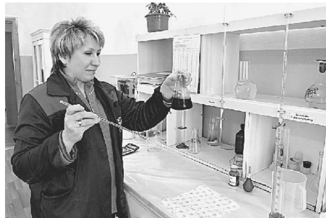
Аппаратчик химводоочистки Вероника Ботова определяет содержание хлора в питьевой воде.
