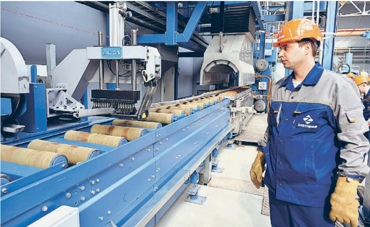
ПРЕССОВАЯ ЛИНИЯ. Скорость линии экструзии – 30 м/мин., производительность – 500 тонн алюминиевого профиля в месяц.
